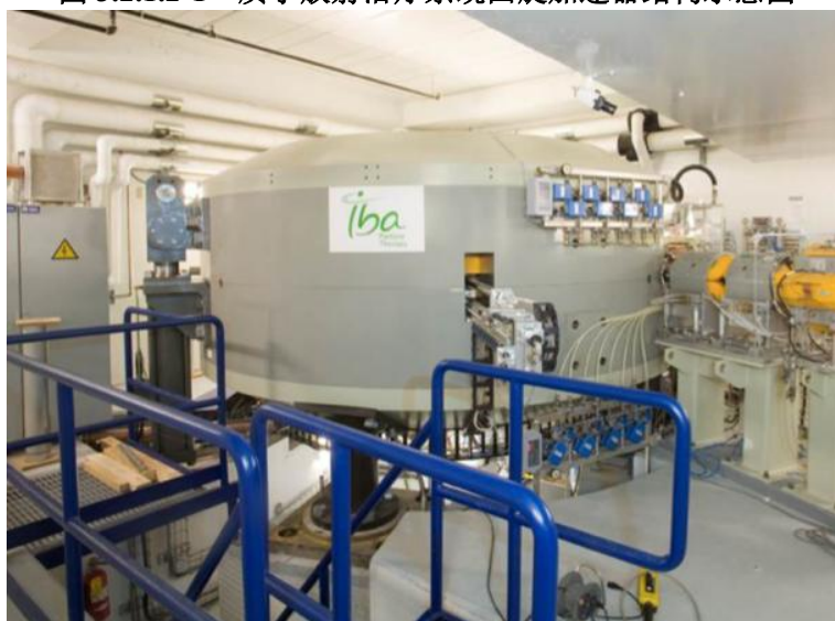
图 3.2.1.2-2 质子放射治疗系统回旋加速器实物参考图
