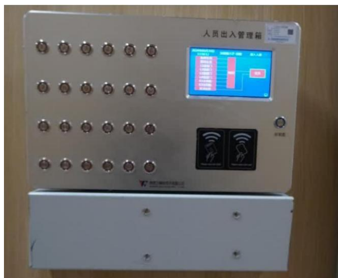
图 4.1.2.1-2 回旋加速器机房门口人员出入管理箱（示意图，红色代表全部就位）
