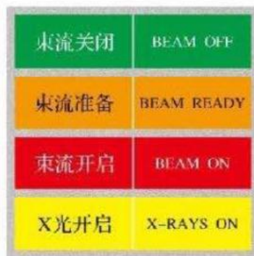
图 4.1.2.1-7 治疗室束流（工作）状态指示灯示意图
