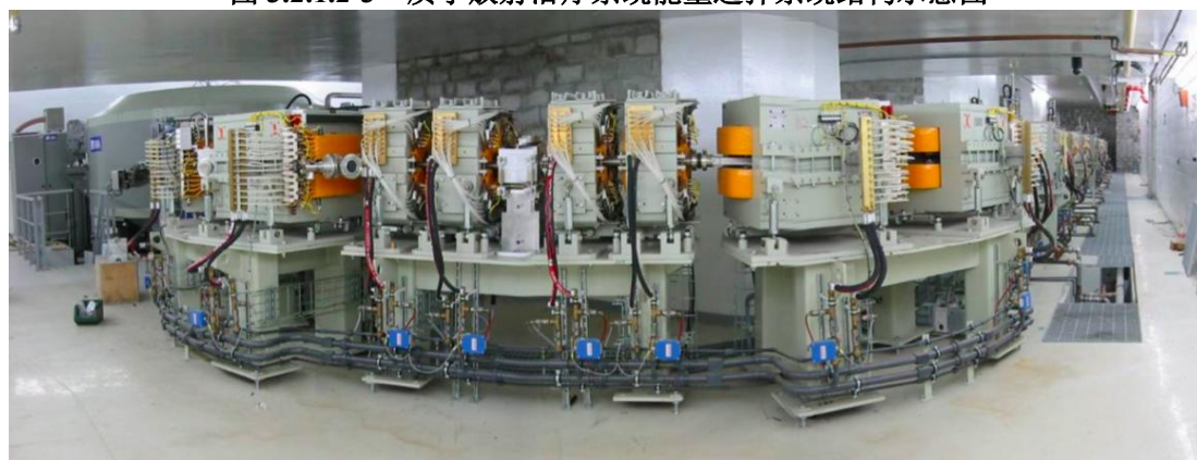
图 3.2.1.2-4 质子放射治疗系统能量选择系统实物参考图
