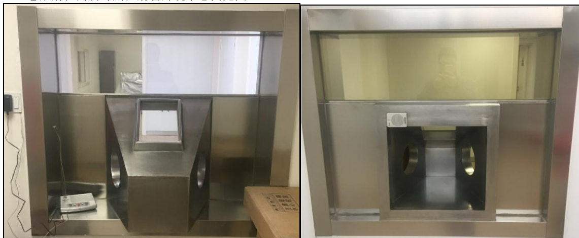
图 10-1 放射性药物专用注射铅窗外观示意图
